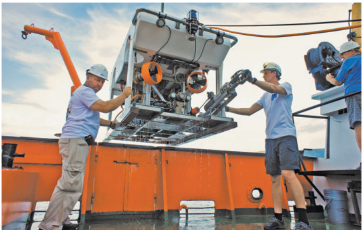
Спуск, испытание и подъем телеуправляемого подводного аппарата демонстрировали прямо у пирса.
