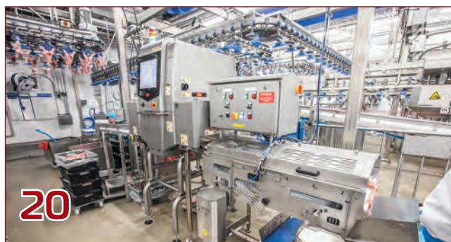
Система рентгеновского контроля для выявления костного остатка в филе
