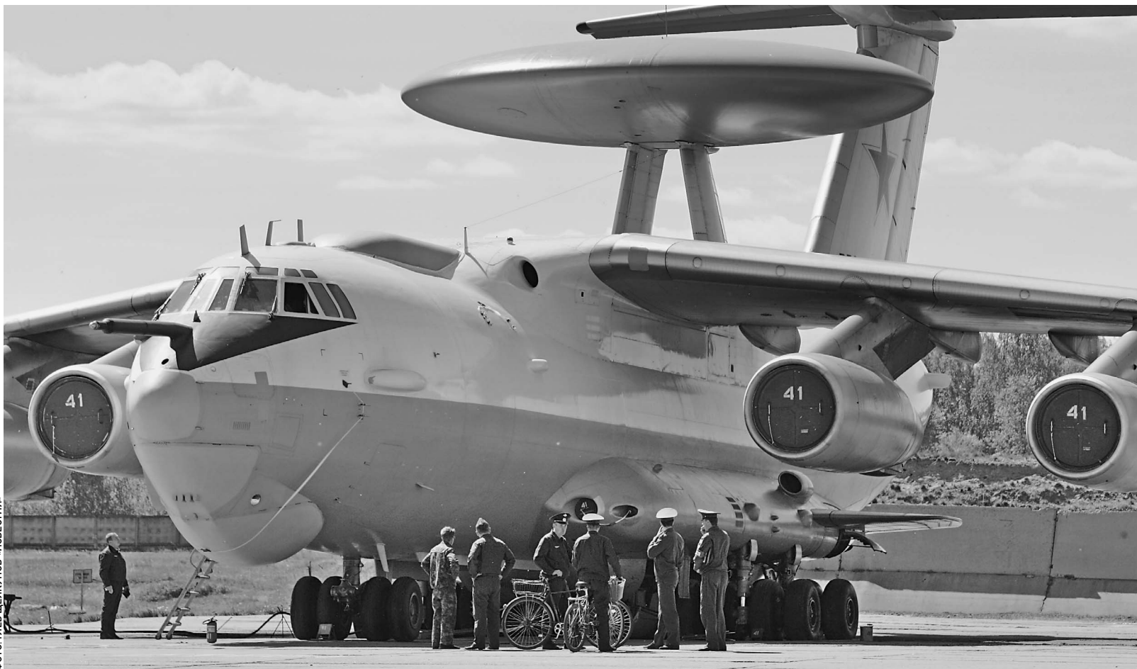
На фюзеляже А-50 находится «гриб»-антенна, а внутри — электронная «начинка», все это позволяет контролировать воздушное пространство на тысячи километров
