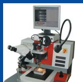
Ультразвуковая сварка силовых приборов плоской алюминиевой лентой (HARB)
